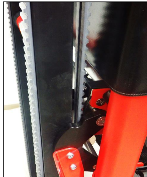
Skinne fastgjort til stoleryggen via skub-til-luk låsene
