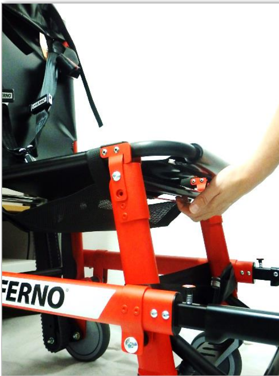
Træk det røde kabel under sædet udad
