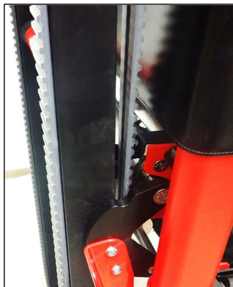
Skinne fastgjort til stoleryggen via skub-til-luk låsene
