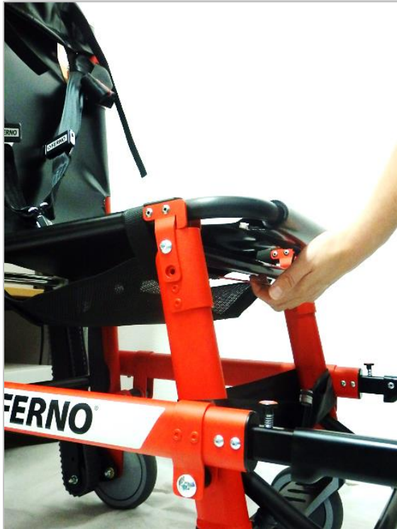
Træk det røde kabel under sædet udad
