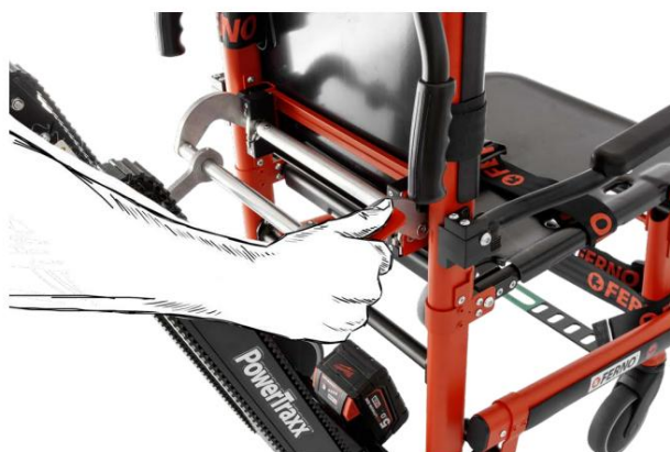
Använda fältet "Tryck för att stänga" för att stuvna undan spåret
